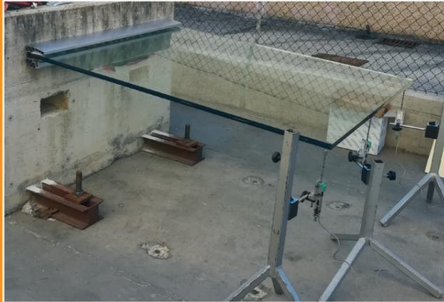
Pensilina prima del test, il sistema è stato testato con una sporgenza massima del vetro di 1,5 m.
