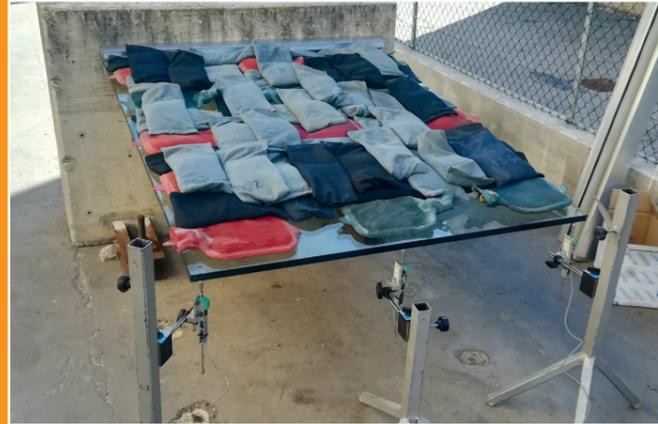
Pensilina durante il test: viene simulato il carico neve corrispondente alle zone alpine, in foto, una pensilina con applicato un carico totale di 300 kg (corrispondenti a  $165 \text{ kg/m}^2$ ).
