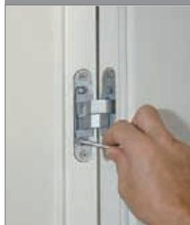
Cerniere invisibili e registrabili sui 3 assi, testate a 200.000 cicli di apertura. Per registrarle basta sollevare la cover ed accedere ai registri che permettono la regolazione millimetrica dell'anta.
