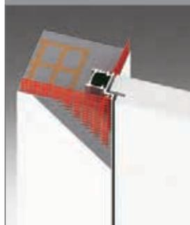
Soluzione unica con sistema brevettato a tripla azione che evita l'insorgenza delle antiestetiche crepe fra parete e telaio: 1) Le staffe bloccano il telaio alla parete. 2) Alle scanalature a "dente di sega" del telaio si aggrappa irreversibilmente l'intonaco. 3) La rete in Kevlar, fissata al telaio, ingabbia la rasatura di rifinitura.
