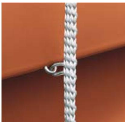
**Collegamento ottimale:** il collegamento brevettato tra lamelle e funicella di supporto avviene tramite un occhiello di acciaio inossidabile, inserito nella bordatura della lamella stessa senza indebolirla.
