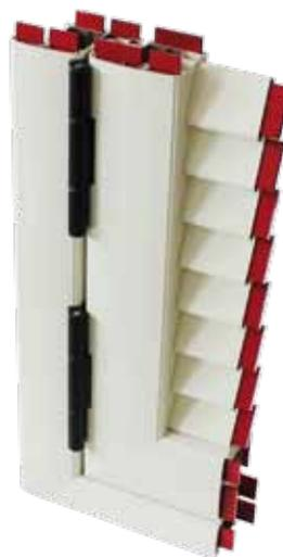
Le lamelle fisse di tipo ovalina sono realizzate con profili in alluminio estruso e sono attraversate da barre di rinforzo in alluminio misura 40x7 mm e penetrano all'interno dei profili dell'anta, garantendo una particolare robustezza all'intero telo persiana.
