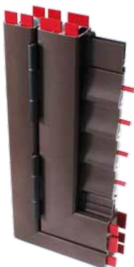
Le lamelle orientabili sono realizzate con profili in alluminio aventi spessori maggiorati e sono attraversate da barre in acciaio del diametro di 9 mm che penetrano all'interno dei profili dell'anta, garantendo una particolare robustezza all'intero telo persiana.
