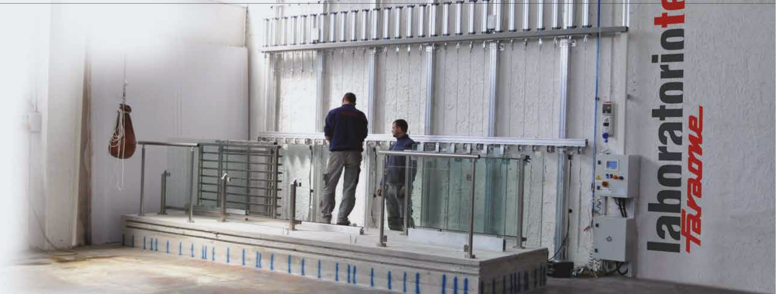
PROVA PENDOLO DA ALTEZZA DI 120 cm. IMPACT TEST FROM A HEIGHT OF 120 cm.
