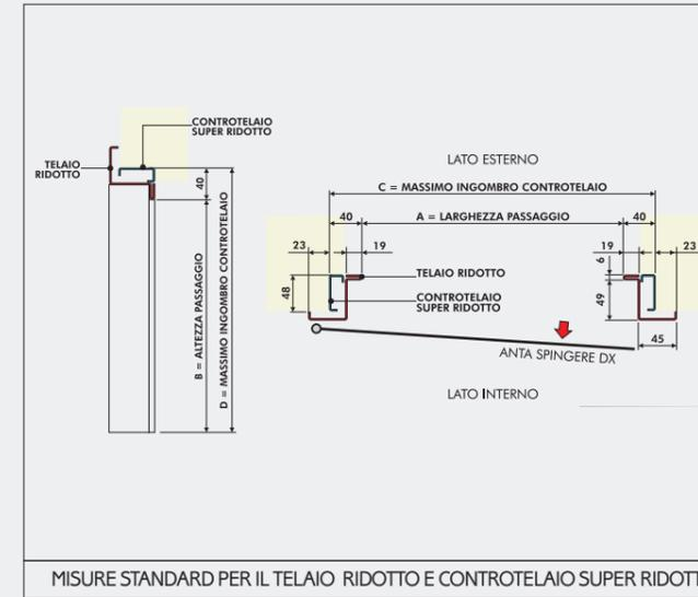
**MISURE PER IL TELAIO RIDOTTO E C. T. SUPER RIDOTTO**
